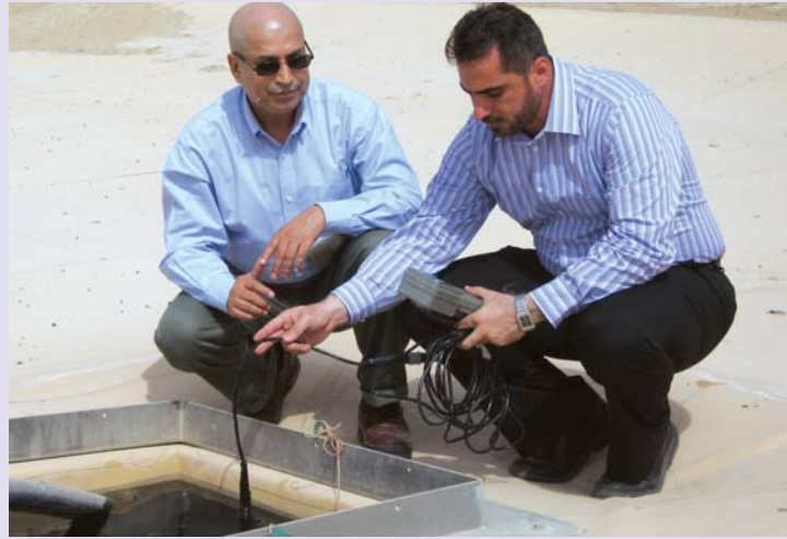
قياس ملوحة أحد خزانات المياه في مقر المركز لتحديد جودة المياه فيه
